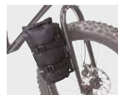
Montaż na widelcu na śrubach do koszyka bidonu
