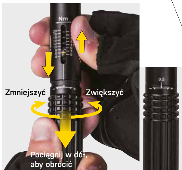
Obróć o pół obrotu, aby wyregulować o 0,5 Nm
