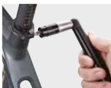
Stosuje prawidłowe wartości momentu obrotowego
