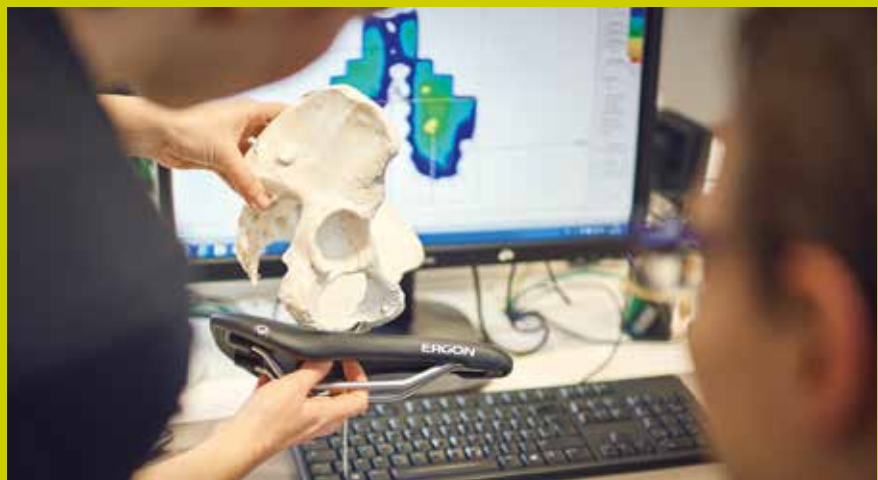
Opracowane serie pomiarów rozkładu nacisku z udziałem wielu testowych rowerzystów ujawniają najmniejsze ergonomiczne problemowe obszary i dodatkowo pomagają naszemu działowi badań i rozwoju udoskonalić zalety naszych siodełek w zakresie zmniejszania nacisku.
